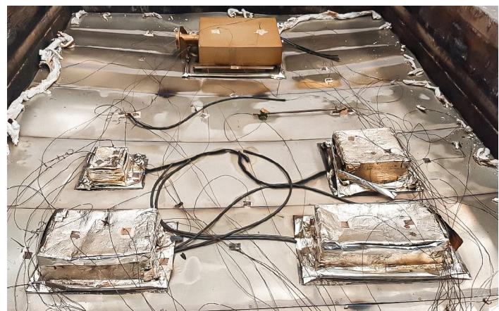
Feuerwiderstandstest für horizontale Trennflächen an Bord von Schiffen mit VitriBond Marine
