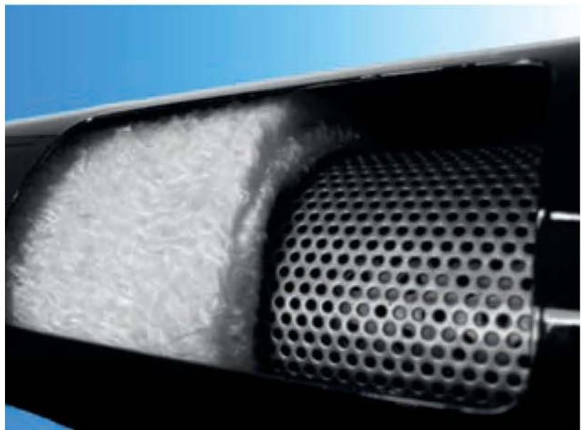
Das Absorptionsmaterial „vergrößert“ sich beim ersten Erhitzen, da die synthetischen Zwirne durch die Abgas-Temperatur schmelzen (bei der optionalen Niedrigtemperatur-Version bei 130 °C oder 80 °C). Durch die „Rückstellkräfte“ der Glasfilamente wird die Schalldämpferkammer ausgefüllt.
